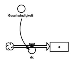
Zusammenfügen der beiden einfachen Integratoren für die Geschwindigkeit und für die Strecke zum doppelten Integrator
